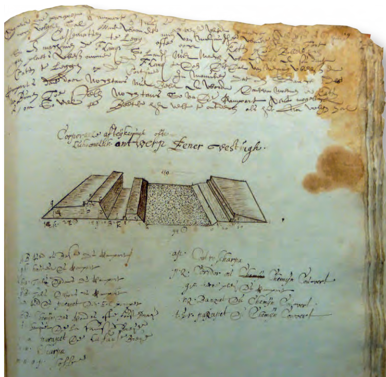
Deze ontwerptekening van een vesting geeft links de stadswal weer met vóórliggende verdedigingsconstructie met gracht, bedekte weg en contrescherpen. Militaire ingenieurs leerden de bouw van vestingwerken uit gedetailleerde handgeschreven instructieboeken met allerlei berekeningsvoorbeelden, zoals hier weergegeven. (Regionaal Historisch Centrum Limburg, Militair handschrift, Maastricht)
