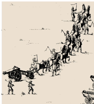
Een half kartouw of een kanon op affuit met een lading van een 24 ponds kogel of kloot, werd getrokken door zes of meer paarden. De vuurmonden waren gemaakt van gegoten brons, waarmee vooral klokkengieters grote ervaring hadden. Kopergravure (detail) door H. Hondius uit: David SOLEMNE, Le Mareschal des Logis , Amsterdam 1653. (Particuliere collectie)
